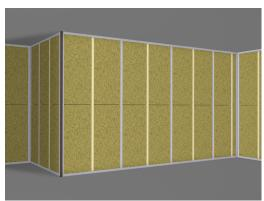
2. Смонтировать электрическую проводку и изоляционный материал. Установить алюминиевый "F"-образный профиль на внешний угол стены. Алюминиевый профиль закрепить к стоечному профилю саморезами ГМ 3,5\*25 мм. На стоечные профили, на которые не приходится стык листов, нанести монтажный клей (например, жидкие гвозди, на органическом растворителе) или усиленный двусторонний скотч.
