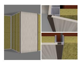
3. В пазы образованные "F"- образным профилем завести стеновые панели, прижать к стоечным профилям с нанесенным клеем или двусторонним скотчем и зафиксировать с помощью "Ω"- образного профиля. "Ω"- образный профиль с одной стороны закрепляет уже установленную панель, а с другой образует паз для следующей.
